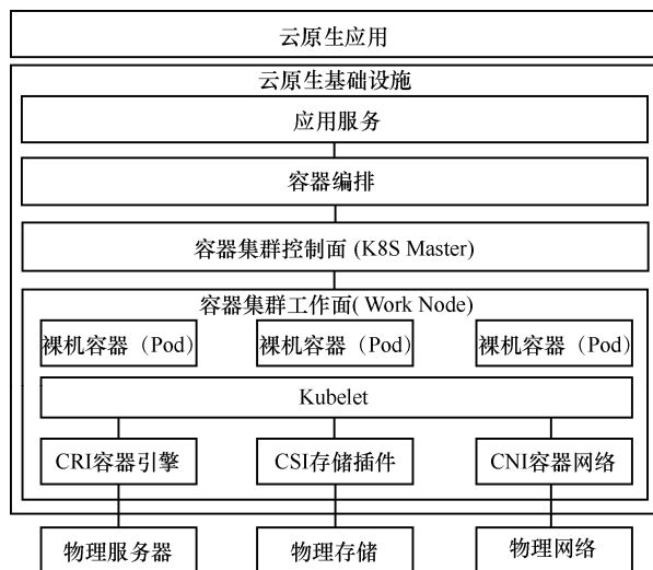
图2 裸机 K8S 云原生基础设施
